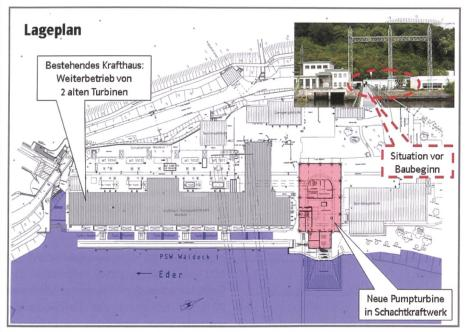
Bild 11. Lageplan der Altanlage mit dem neuen Schachtkraftwerk.
