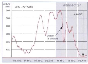
Bild 3. Windeinspeisung in E.ON-Regelzone.
