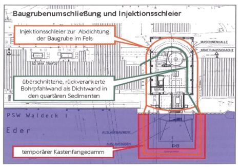
Bild 12. Lageplan Schachtkraftwerk mit Baugrubenumschliessung und Injektionsschleier.
