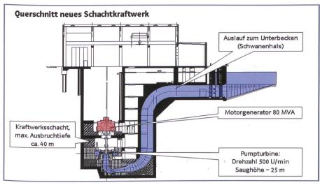
Bild 7. Querschnitt durch das neue Schachtkraftwerk.
