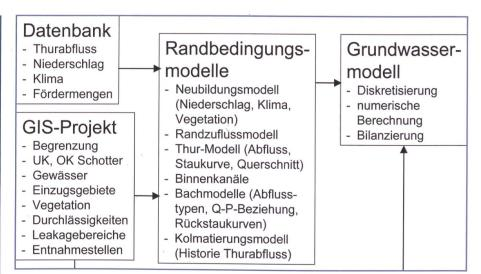
Bild 1. Aufbau des Grundwassermodells aus dem konzeptuellen Modell.
