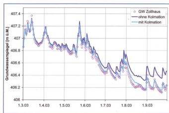
Bild 7. Kalibrierung der Kolmationsfunktion am Beispiel des Niederwassers 2003.
