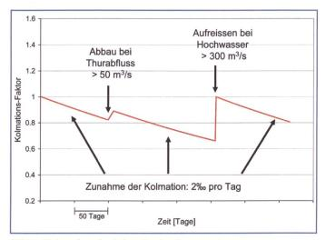
Bild 5. Kolmationsfunktion des Leakagewertes.
