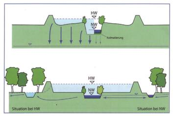
Bild 3. Schematische Querprofile durch die Thur.
