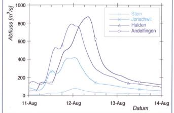
Bild 4. Gemessene Abflussganglinien des Hochwassers vom 12. August 2002 an 4 Messstationen der Thur.
