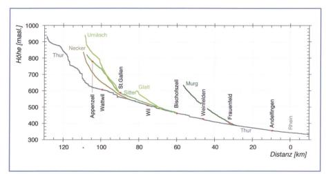
Bild 2. Längenprofil von Thur und bedeutenden Zuflüssen.
