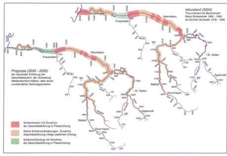
Bild 11. Transportierte Geschiebefrachten im Istzustand und bei maximaler Erhöhung der Geschiebezufuhr. Angaben in [m³/a].
