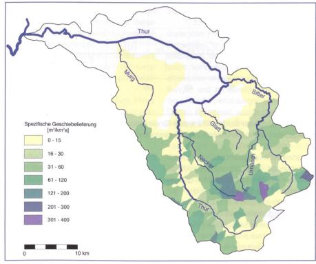
Bild 8. Spezifische Geschiebelieferung in Teileinzugsgebieten der Thur.
