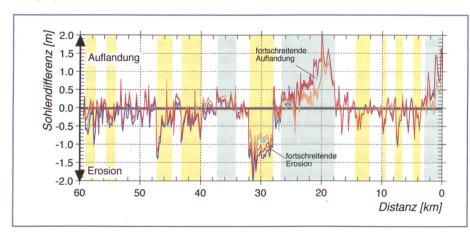
Bild 9b. Längenprofil der Sohlendifferenzen für die Fälle gemäss Bild 9a.
