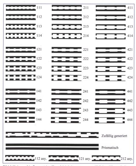
Bild 4. Untersuchte Geometrien (Draufsicht) der grossmassstäblichen Uferrauheiten.
