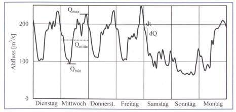
Bild 1. Typische Abflussschwankungen für eine Oktoberwoche im Jahre 2003 an der Rhone in Porte du Scex beim Eintritt in den Genfersee und Definition der Schwallkennwerte.  $Q_{max}$ : täglicher Maximalabfluss;  $Q_{min}$ : täglicher Minimalabfluss;  $Q_{mittel}$ : mittlerer täglicher Abfluss.
