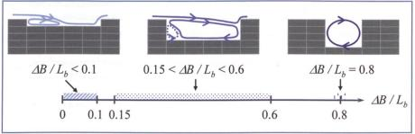
Bild 6. Aufteilung der Geometrien in Fliesstypen unter Berücksichtigung von  $\Delta B/L_b$ : «wiederanlegende Buchtenströmung» ( $\Delta B/L_b < 0,1$ ); «langgezogene Rotationsströmung in Bucht (2 Zellen)» (0,15 <  $\Delta B/L_b < 0,6$ ); «kreisförmige Rotationsströmung in Bucht (1 Zelle)» ( $\Delta B/L_b \cong 0,8$ ).
