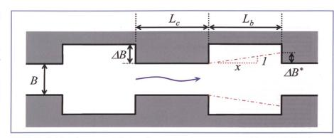
Bild 3. Definition der geometrischen Parameter der grossmassstäblichen Rauheiten der Ufer. Variable Parameter sind die Buchtenlänge  $L_b$  und deren Abstand  $L_c$  sowie die Tiefe  $\Delta B$ . Die Basisbreite B=0,5 m ist konstant. Die effektive Breite im Fliesswiderstandsmodell ist definiert als  $\Delta B^*=L_b/x$ .
