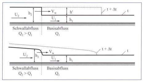
Bild 2. Fortbewegung einer Schwallwelle im horizontalen, reibungsfreien Rechteckkanal (oben) und im geneigten Gerinne mit Fliesswiderstand (unten).
