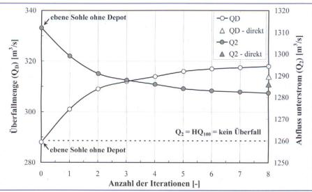
Bild 5. Seitliche Überfallmenge ( $Q_D$ ) und im Gerinne weitergeführter Durchfluss ( $Q_D$ ) für einen Zufluss von EHQ = 1600 m<sup>3</sup>/s in Abhängigkeit der Depothöhe bzw. der Iterationsschritte.
