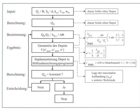
Bild 3. Schematische Übersicht des Bemessungskonzeptes und Berechnungsvorgang.
