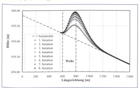
Bild 4. Entwicklung des Depots für verschiedene Iterationsschritte.
