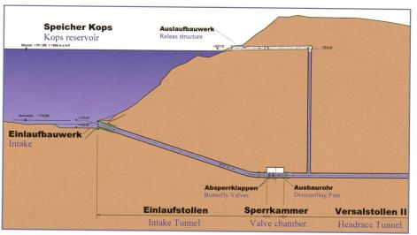
Bild 3. Einlaufstollen Kops und Sperrkammer, Längsschnitt.
