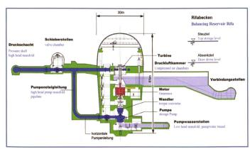
Bild 2. Kavernenkrafthaus, Querschnitt.
