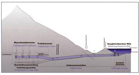
Bild 7. Unterwasserführung Längsschnitt.
