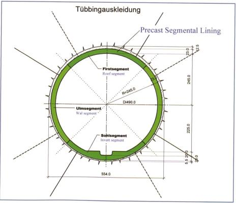
Bild 4. Druckstollen, Regelquerschnitt Volltübbingauskleidung.
