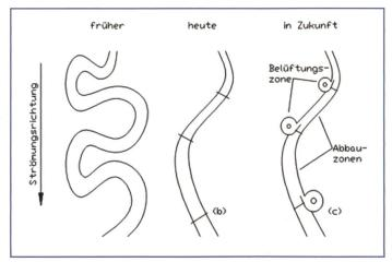
Bild 4. Eine mögliche Entwicklung der Fliessgewässer, (a) früher mäanderförmig, (b) heute reguliert mit Sohlstufen und in Zukunft (c) mit integrierten Rotationsbecken zur Wasserbelüftung und zur Gewinnung elektrischer Energie.
