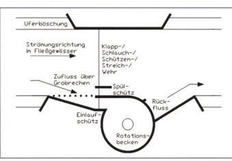
Bild 5. Schematischer Aufbau eines Gravitationswasserwirbelkraftwerks.
