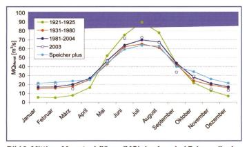
Bild 2. Mittlere Monatsabflüsse (MQ) der Aare bei Brienzwiler in den Perioden 1921–1925 (kein Kraftwerks-Einfluss), 1931–1980 (Speicherbetrieb der KWO) und 1981–2004 (Pumpspeicherbetrieb der KWO), im Hitzejahr 2003 sowie prognostizierte Abflüsse nach dem Höherstau des Grimselsees gemäss Ausbauprojekt der KWO (Speicher plus). Abbildung aus Limnex (2006).
