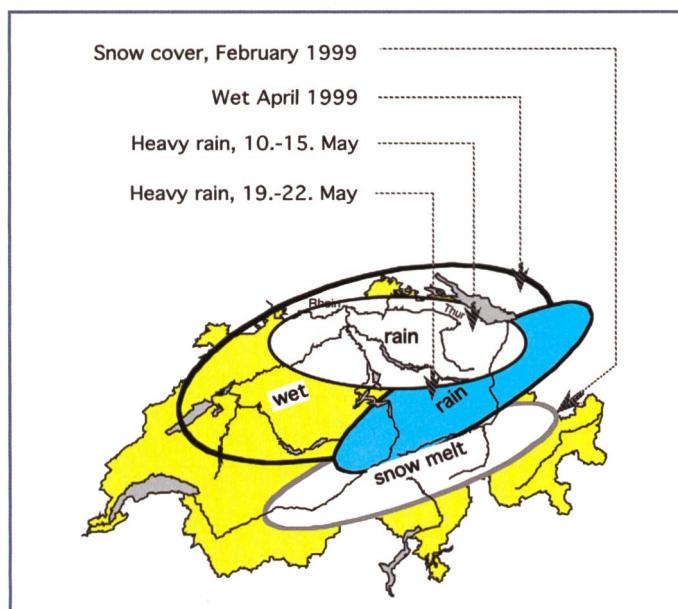
**Bild 2. Schema der zeitlichen Folge und räumlichen Verteilung der Abflussbeiträge in der Hochwasserperiode Mai und Juni 1999. Große Ellipse: Hochwassergebiet. (Grebner und Gurtz, 2003).**
