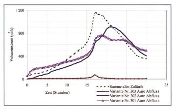
Bild 11. Volumenströme des Totals der Zuläufe und der Abfluss der Aare bei Handeck bei PMF für die Varianten 301–303.
