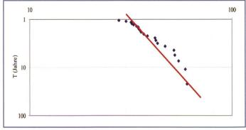
Bild 3. Berechnung des Tagesmittelwertes Q<sub>20, Tagesmittelwert</sub> durch Anwendung des Gesetzes von Gumbel auf eine Serie von maximalen Jahres-Tagesmittelwerten für den Zufluss des Grimselsees in der Periode 1980 bis 2001.
