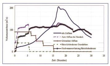
Bild 8. Variante 212, Optimierte Betriebsführung bei Q<sub>20</sub> zur Minimierung der Abflussmenge der Aare bei Handeck.
