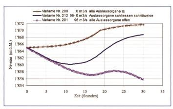
Bild 6. Grimselsee, Wasserspiegelkurve für  $Q_{20}$  der Varianten Nr. 201, 208 und 212.
