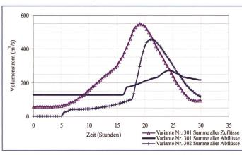
Bild 10. Grimselsee, Volumenströme der Zu- und Abflusse bei PMF für die Varianten 301 und 302.
