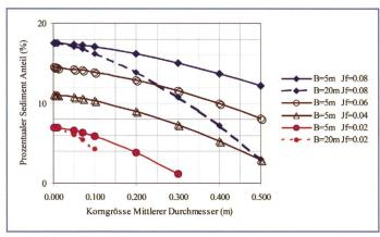
Bild 5. Prozentualer Sedimentanteil von Korngrössen zwischen 0,001 m und 0,5 m, einer Flussbettbreite von 5 m und 20 m und in Funktion der Flussbettneigung J<sub>f</sub>.
