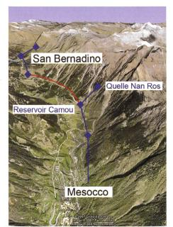
Bild 1. Mit der neuen Feuerlöschleitung (rot) entlang der Nationalstrasse N13 hätte eine umfassende Trinkwasserschiene im Misox realisiert werden können. Das Konzept hat vier entsprechend positionierte Turbinenstationen vorgesehen. Nun wird zunächst die neue Quelle Nan Ros erschlossen, in Camou Strom produziert und die Wasserversorgung für Mesocco verbessert.
