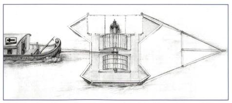
Bild 5. Warp-Maschine von Pierre de Dromec. Antrieb der Winde mit Wasserrädern und Verstärkungsmöglichkeit mit Kurbel an einem Getriebe, um 1700. Skizze undatiert (Staatsarchiv Luzern).
