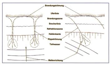
Bild 9. Strömungen im ufernahen Flachwasser, links bei senkrechtem Anlauf, rechts bei schrägem Anlauf der Wellen.
