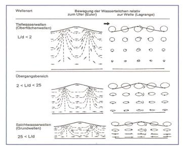
Bild 7. Wellenströmungen in tiefem und in seichtem Wasser
