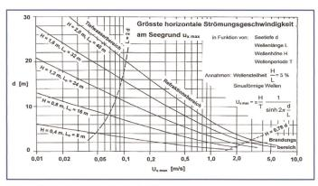
Bild 8. Grösste horizontale Strömungsgeschwindigkeit am Seegrund in Funktion von Seetiefe und den Wellenparametern Wellenlänge und Wellenhöhe.
