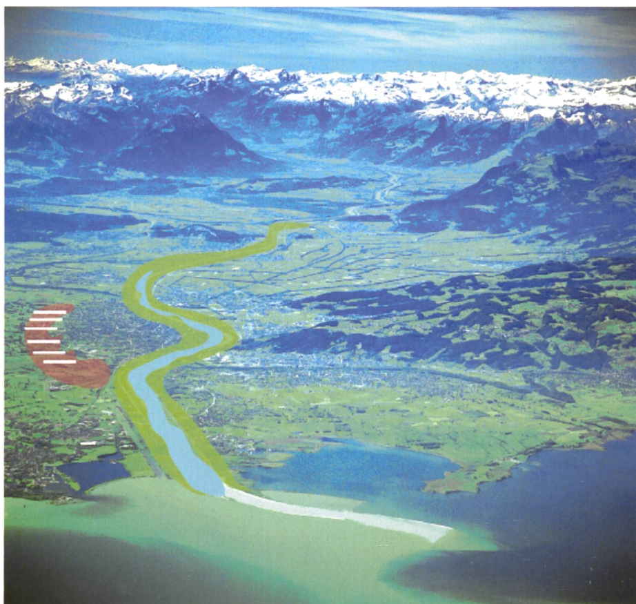
Bild 9. Szenario: Notentlastung bzw. Aufweitung, Abflusserhöhung, Renaturierung.
