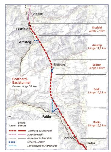
Bild 6. S-förmige Linienführung des Gotthard-Basistunnels.
