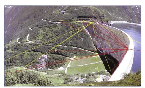
Bild 15. Überwachungskonzept Stauanlagen.
