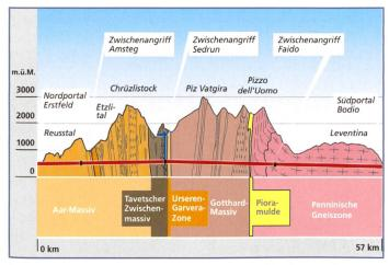
Bild 7. Geologisches Längenprofil Gotthard-Basistunnel.
