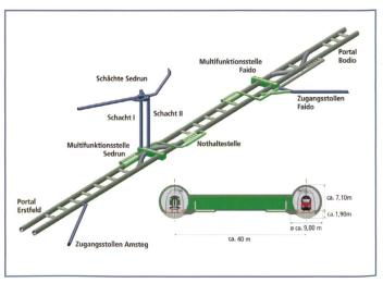
Bild 5. Tunnelsystem Gotthard-Basistunnel.
