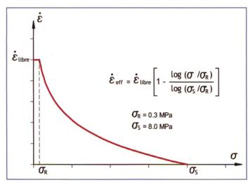
Figure 4. Réaction alcali-granulat, effet des contraintes de compression sur la vitesse de gonflement.
