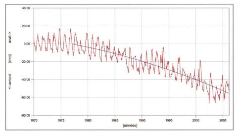
Figure 2. Déplacement radial en clef au couronnement.
