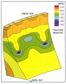
Figure 9. Contraintes tangentielles après le sciage.
