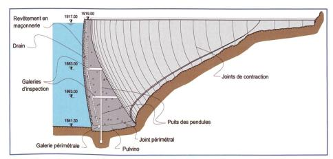
Figure 1. Profil type du barrage.
