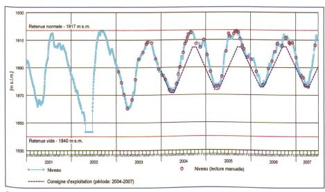
Figure 8. Consignes d'exploitation avec limite de vidange.
