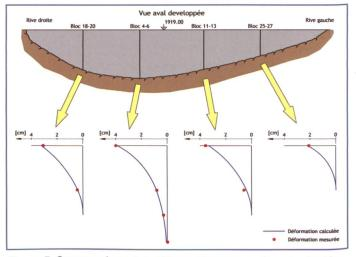
Figure 5. Comparaison des déformations mesurées et calculées.
