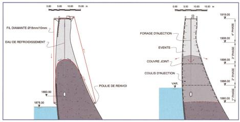
Figure 11. Phases de réalisation: sciage des plots et clavage des joints.
