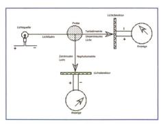
Bild 4. Schema der turbidimetrischen und nephelometrischen Methode.
