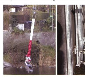
Bild 2. Schwebstoffbeobachtung, links: Beprobung mittels Seilflügelanlage; rechts: Trübungssonde.
