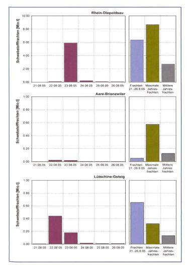
Bild 14. Die Ermittlung der Schwebstofffracht während dem Hochwasser im August 2005 beruht auf Konzentrationswerten, die mittels ARC-Methode abgeschätzt wurden.
