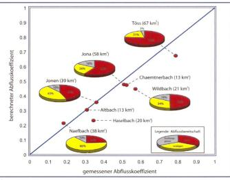
Bild 12. Gegenüberstellung von berechneten und gemessenen Abflusskoeffizienten von 8 Einzugsgebieten im Kanton Zürich beim Hochwasser im Mai 1999. Die Abflusskoeffizienten wurden anhand der gemessenen Niederschläge und der ermittelten Prozessflächen berechnet. Der Abflusskoeffizient vergrössert sich mit zunehmendem Anteil an schnell beitragenden Gebieten.
