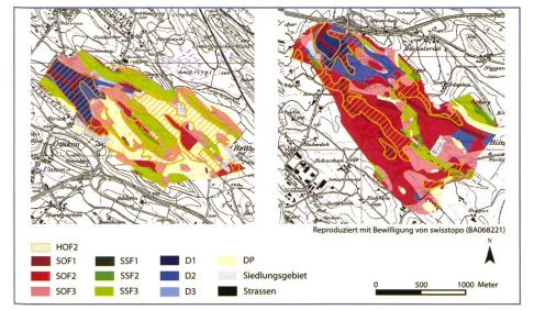
Bild 9. Das Isert-Einzugsgebiet (links) wird von verzögert reagierenden SOF- und SSF-Flächen und nicht beitragenden Gebieten mit Tiefenversickerung dominiert, während in Ror (rechts) rasch reagierende Sättigungs- und Drainageflächen vorherrschen.
