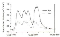
Bild 2. Beim Hochwasser im Mai 1999 übertrifft der spezifische Abfluss von Ror bei vergleichbaren Niederschlägen denjenigen von Isert um das Doppelte.
