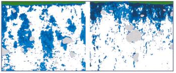
mit hoher Intensität mit blau gefärbtem Wasser. Im Rietholzbach ist das Wasser tief eingedrungen, im Heitersberg wurde v.a. die oberste Schicht benetzt und es bildete sich rasch Oberflächenabfluss.
