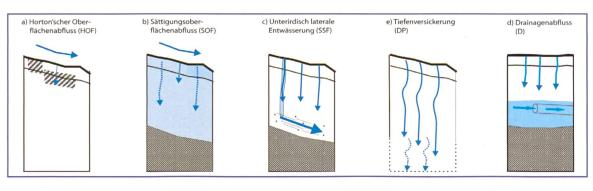
Bild 5. Schematische Darstellung der fünf dominanten Abflussprozesse.
