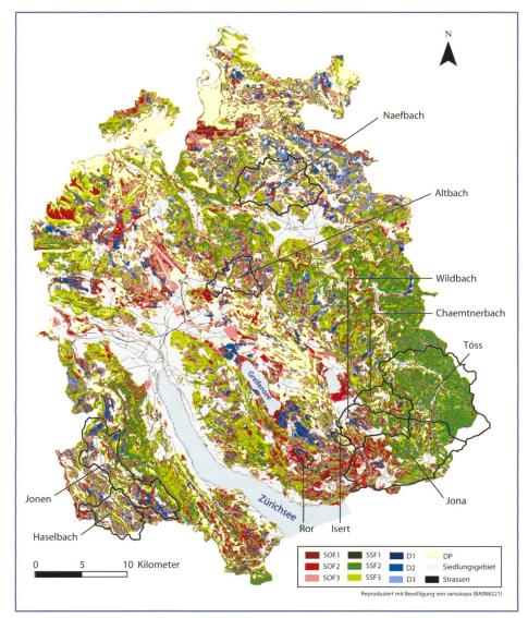
Bild 8. Automatisch hergeleitete Abflussprozesskarte des Kantons Zürich. Die eingezeichneten Einzugsgebiete werden im Text erwähnt.
