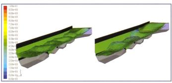
Bild 3. Wasseroberfläche Scherlibach, eingefärbt nach der Fliessgeschwindigkeit.
