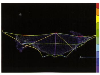
Bild 10. Berechnung Murgangnetze mit der Software «FARO».
