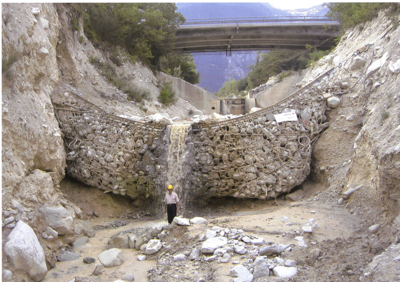
Bild 5. Feldversuch Illgraben, Wallis: 18. Mai 2006, total 15000 m 3 Geschiebe, davon 1000 m 3 zurückgehalten, der Rest überströmte die hinterfüllte Barriere.
