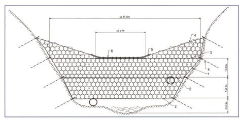
Bild 8. Murgangrückhaltesysteme Typ Geobrugg, System VX ohne Stützen.
