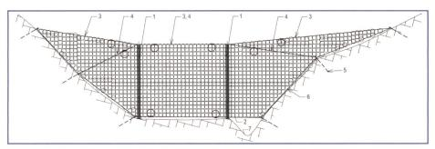
Bild 9. Murgangrückhaltesysteme Typ Geobrugg, System UX mit Stützen.
