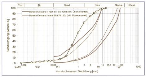
Bild 3. Kornverteilung Probe Nr. 1 (exemplarisch), Transgeo AG, Gümligen, 2006.
