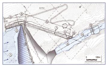
Bild 3. Situation der Hochwasserentlastungsanlage: (1) Hálslón-Reservoir, (2) Hauptdamm Kárahnjúkar, (3) Überfallkrone, (4) Sammelkanal, (5) Übergangsbereich, (6) Schussrinne, (7) Sohlbelüfter, (8) obere Absprungkante, (9) unteres Plateau, (10) untere Absprungkante, (11) Schlucht mit Auffangbecken und (12) Unterwasserdamm.
