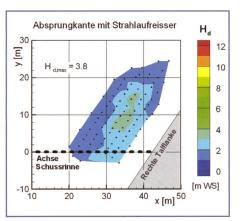
Bild 11. Verteilung der mittleren dynamischen Druckhöhen  $H_d$  im Auffangbecken in einer Tiefe von ca. 7,5 m bei 600 m³/s für (a) Absprungkante ohne Strahlaufreisser, und (b) mit Strahlaufreissern.
