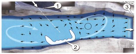
Bild 12. Strömungsmuster im Auffangbecken mit den zwei dominierenden Walzen bei 950 m<sup>3</sup>/s. (1) Untere Absprungkante, (2) Strahlauftreffbereich und (3) Unterwasserdamm.
