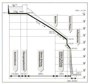
Bild 5. Längsprofil der Hochwasserentlastungsanlage.
