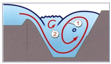
Bild 8. Schematische Skizze der Fliessstruktur im Sammelkanal im Schnitt mit der typischen Spiralströmung (1) und der Deckwalze (2).
