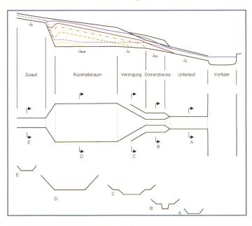
Bild 13. Schematische Darstellung des Rückhalteraumes und der Entwicklung der Ablagerungen (von der gelben über die orange bis zur roten Linie) und Wasserspiegellagen (blaue Linien).
