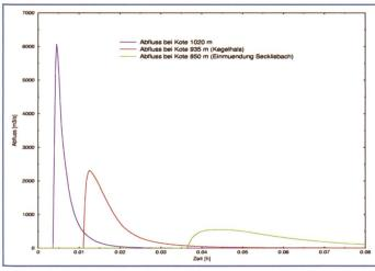
Bild 11. Verformung der Murgangwelle entlang des Fliessweges im Haldibach.
