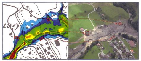
Bild 10. Vergleich zwischen berechneter und beobachteter Übermurung auf dem Schwemmkegel des Haldibaches, von der Mündung in den Secklisbach.
