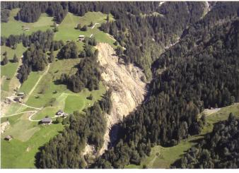
Bild 8. Rutschung Schmidsboden, Aufnahme vom 30. August 2005. Mobilisiert wurden insgesamt 250 000 m³, die in mehreren Schüben als Murgänge ins Tal flossen.
