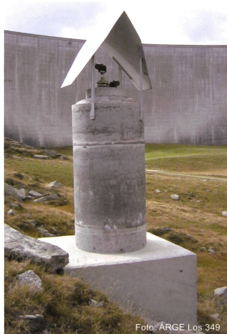
Bild 9. Beobachtungspunkt auf doppelwandigem Pfeiler.
