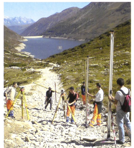
Bild 2. Präzisionsnivellement in schwierigem Gelände.
