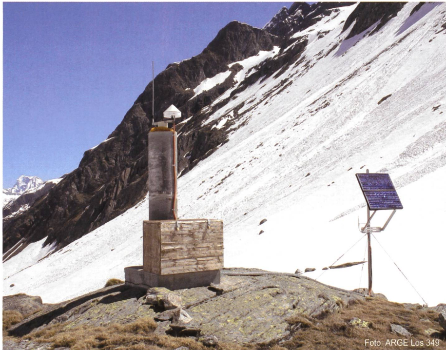
Bild 12. GPS-Messpfeiler mit Antenne, Blitzfangstange, Elektronikbox und Solarpanel.
