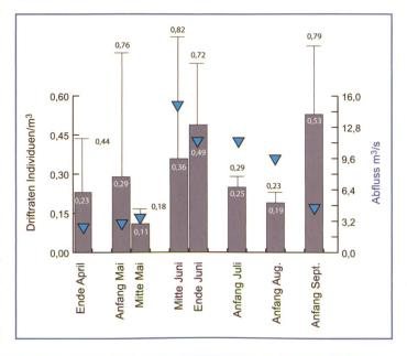
Bild 14. Eindrift-Raten von Zoobenthosorganismen in den neuen Flaz nach seiner Flutung Ende April 2004, Individuen/ m3, Mittel (graue Säulen) und Tagesmaxima (Strichbalken). Blaue Dreiecke: Abfluss (Pegel Berninabach), Tagesmittel der Driftmesstage.
