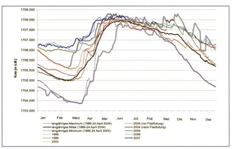
Bild 2. Jahresganglinien der Grundwasserstände an der Messstelle 360E: Die dargestellten langjährigen Messwerte (Maximal, Mittel- und Minimalwerte) entsprechen den Daten vor der 1. Flazflutung (1986 bis 24. April 2004). Auf der Grafik ist gut erkennbar, dass seit der Flazflutung die Winterwasserstände höher sind als früher. Die Sommerwasserstände hingegen haben sich nur leicht erhöht und liegen im Bereich der früheren maximalen Grundwasserstände (Daten: Amt für Natur und Umwelt, 2007).
