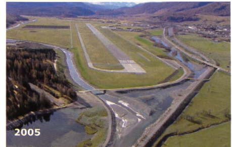
Bild 8. Rechte Bildleiste: Neue Flazmündung (Blick von Gravatscha En-aufwärts in südlicher Richtung): Die neue Flazmündung unterhalb von Samedan stellt eine technische Lösung mit naturnahen Elementen dar. Damit das Wasser von Gravatscha nicht durch Flazwasser, welches häufig Gletschermilch enthält, getrübt wird, wird der See durch einen Düker unter dem Flaz hindurch mit Enwasser gespeist. Der auf der linken Flazseite in die Mündung vorgezogene Sporn wurde zwischenzeitlich stark abgetragen.
