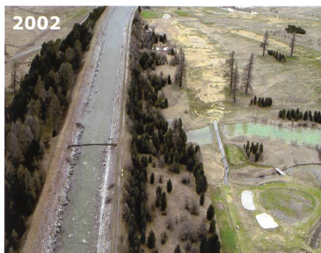
Bild 13. Flaz vegl (Blick bachabwärts in westlicher Richtung): Im ehemaligen Flazkanal fliesst heute der renaturierte Lauf des Flaz vegl mit noch maximal 1,5 Kubikmeter Wasser pro Sekunde. Die alten Flazdämme konnten zurückgebaut werden, die Vegetation schliesst langsam die «Wunden» in der Landschaft. Der rund 2,5 km lange Lauf des Gebirgsbachs hat sich bereits zu einem beliebten Naherholungsgebiet entwickelt.
