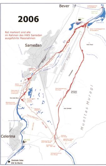
Bild 1a. Durch die Flussverlegung des Flaz konnte eine umfassende Restrukturierung der Gewässer in der Ebene von Samedan umgesetzt werden. Insgesamt wurden rund 13 km Fliessstrecken und dazugehörige Uferflächen neu gestaltet (rot markierte Abschnitte).
