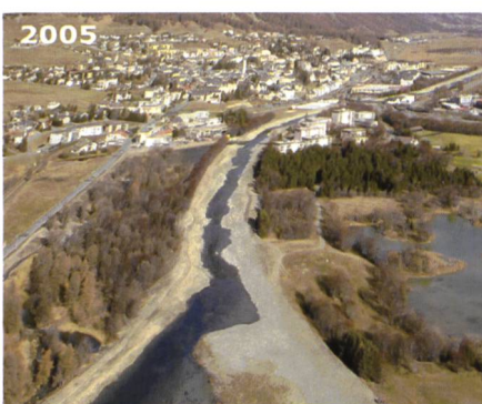
Bild 11. Zusammenfluss von Flaz vegl und En (Blick von Champagnatscha En-abwärts in nördlicher Richtung): Die auffälligste Veränderung im Bereich der alten Flazmündung ist die nun veränderte Wasserführung. Während 2003 En (von links) und der durch Gletschermilch getrübte Flaz (von rechts) noch weitgehend unvermischt durch Samedan flossen, enthält das nun restrukturierte En-Gerinne seit 2005 nur noch Wasser aus En und Flaz vegl.
