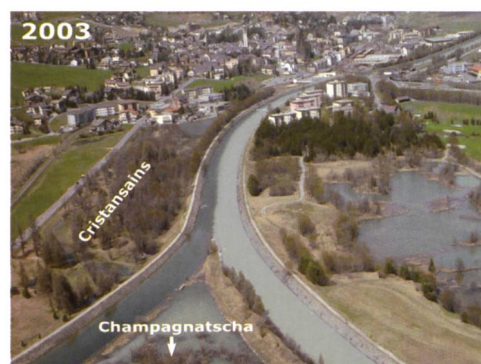
Bild 11. Zusammenfluss von Flaz vegl und En (Blick von Champagnatscha En-abwärts in nördlicher Richtung): Die auffälligste Veränderung im Bereich der alten Flazmündung ist die nun veränderte Wasserführung. Während 2003 En (von links) und der durch Gletschermilch getrübte Flaz (von rechts) noch weitgehend unvermischt durch Samedan flossen, enthält das nun restrukturierte En-Gerinne seit 2005 nur noch Wasser aus En und Flaz vegl.
