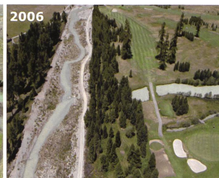
Bild 13. Flaz vegl (Blick bachabwärts in westlicher Richtung): Im ehemaligen Flazkanal fliesst heute der renaturierte Lauf des Flaz vegl mit noch maximal 1,5 Kubikmeter Wasser pro Sekunde. Die alten Flazdämme konnten zurückgebaut werden, die Vegetation schliesst langsam die «Wunden» in der Landschaft. Der rund 2,5 km lange Lauf des Gebirgsbachs hat sich bereits zu einem beliebten Naherholungsgebiet entwickelt.
