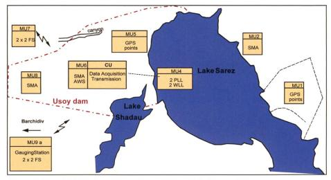
Figure 7. Vue générale du système d'ausculation de la digue d'Usoy.
