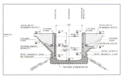
Bild 6. Schnitt durch den Schleusentrog Augst mit alter (schräger) und neuer (senkrechter) Schleusenwand.
