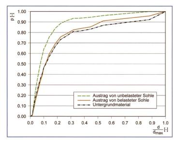
Bild 5. Kornverteilung des ausgetragenen Materials, Beispiel aus Modellversuch.
