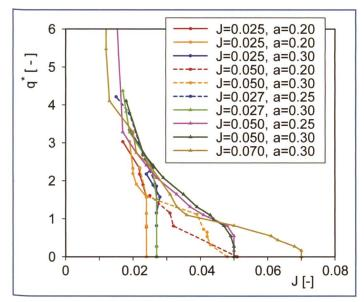
Bild 5. Rampengefälle J in Abhängigkeit des dimensionslosen spezifischen Abflusses q\* für Belegungsdichten a von 0,2, 0,25 und 0,3 sowie Ausgangsgefällen  $J_A$  von 2,5, 2,7, 5,0 und 7,0%.
