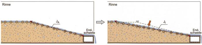
Bild 4. Prinzipielles Verhalten einer unstrukturierten Blockrampe im Falle zunehmender hydraulischer Belastung (links: Ausgangssituation, rechts: Abflachung des Rampengefälles infolge Rotationserosion).
