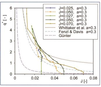
Bild 6. Vergleich der Versuchsdaten mit den Resultaten der Berechnungsverfahren nach Whittaker et al. (1988) und Fenzl und Davis (1964) für eine Belegungsdichte von a = 0,3 sowie einer Exposition der Blöcke von p = 0,7. Zusätzlich ist der Ansatz nach Günter (1971) für die Stabilitätsgrenze des Grundmaterials ohne Blöcke dargestellt.
