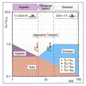
Bild 2. Bewegungsverhalten von bimodalen Mischungen nach Raudkivi und Ettema (1982). Zusätzlich gezeigt sind die Ergebnisse aus Versuchen mit zwei unterschiedlichen Blockgrössen, die zur Bestimmung des Korngrössenverhältnisses mit den charakteristischen Korndurchmessern d<sub>m</sub> bzw. d<sub>90</sub> normiert wurden.
