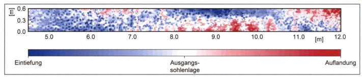
Bild 9. Konturplot des Rampenbereichs für jenen Versuch mit einem Ausgangsrampengefälle von 7% und einer Belegungsdichte von 0,3 nach einem spezifischen Abfluss von  $q^*=1$  (alle Eintiefungen sind blau, alle Auflandungen sind rot dargestellt).
