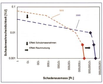
Bild 5. Risikokurven im W/A-Diagramm für die Jahre 1910 (indexiert) und 2005 am Fallbeispiel des Taschinasbaches.
