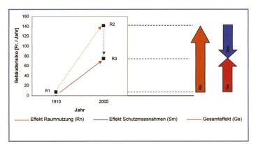
Bild 4. Isolierter Einfluss der Raumnutzung bzw. der Schutzmassnahmen auf die Entwicklung des Gebäuderisikos und resultierender Gesamteffekt. Die x-Achse bezieht sich nur auf die Raumnutzung. Qualitative Risikoentwicklung.
