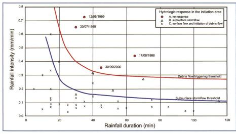
Bild 7. Niederschlags-Intensitäts-Diagramm für Regenereignisse im Gebiet Acquabona von 1996 bis 2000 (aus: Berti and Simoni, 2005).
