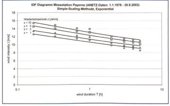
Bild 5. IDF-Diagramm Messstation Payerne, Simple-Scaling-Methode, Exponential.
