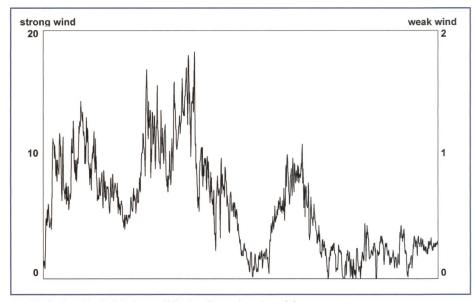
Bild 3. Selbstähnlichkeit von Winden (Angaben in m/s).
