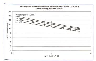
Bild 4. IDF-Diagramm Messstation Payerne, Simple-Scaling-Methode, Gumbel.
