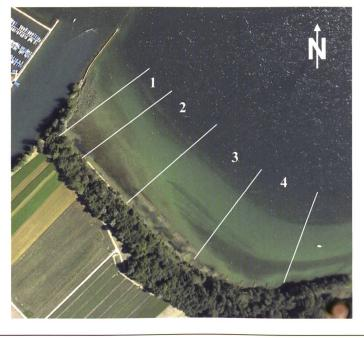
Bild 1. Projektgebiet Naturschutzgebiet Gals, südöstlich der Zihlmündung. Aufnahme von 2005. Ausgeführte Massnahmen: Abschnitt 1: unbefestigtes Ufer, Abschnitt 2: Kiesschüttung, Abschnitt 3: Wellenbrecher, Abschnitt 4: Buhnen.
