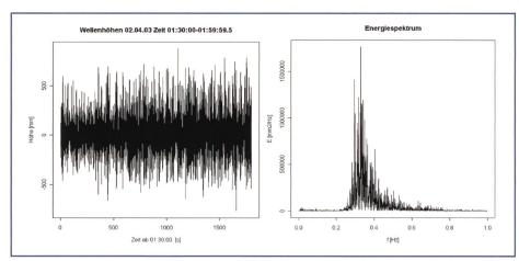
Bild 3. Zeitreihe der Messdaten und Energiespektrum eines Wellenereignisses am 2. April 2003, 01:30:00 – 01:59:59 Uhr, Sutz-Lattrigen.
