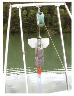
Bild 6. Kurzkerngerät zur Entnahme ungestörter Sedimentproben (Gerät und Foto: Gewässer- und Bodenschutzlabor des Kantons Bern).
