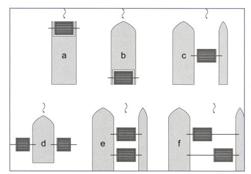
Bild 3. Schema möglicher Typen von Schiffmühlen.
