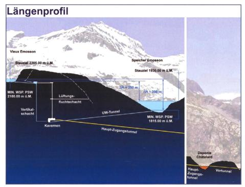
Bild 2. Geplant sind zwei Vertikalstollen für das Triebwassersystem.
