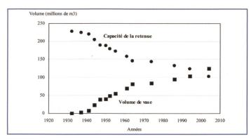
Fig 4. Evolution dans le temps de la capacité du barrage Oued El Fodda.
