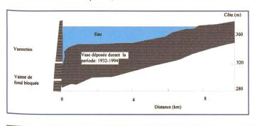
Fig 1. Dépôt de vase dans la retenue du barrage de Oued El Fodda évalué à plus de 120 millions de m<sup>3</sup> en 2002.
