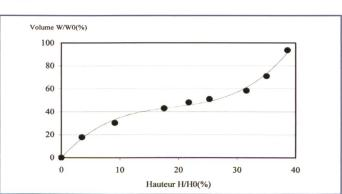
Fig 5. Evolution de la capacité de la retenue en fonction de la hauteur d'eau.
