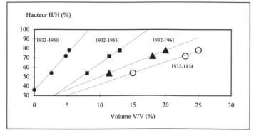
Fig 6. Evolution des dépots de vase dans la partie centrale de la retenue.
