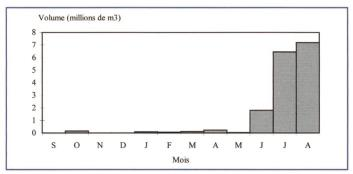
Fig 11. Barrage de Oued El Fodda. Quantité mensuelle de suspension soutirée (Periode: 1980–1992).
