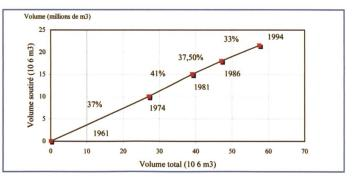
Fig 13. Evolution dans le temps de l'efficacité des soutirages éffectués au barrage de Oued El Fodda.
