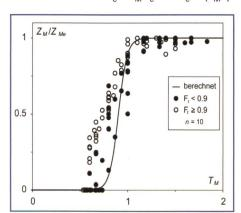
Bild 5. Vergleich der zeitlichen Entwicklung der relativen Kolktiefe nach Experiment und Gl. (6).
