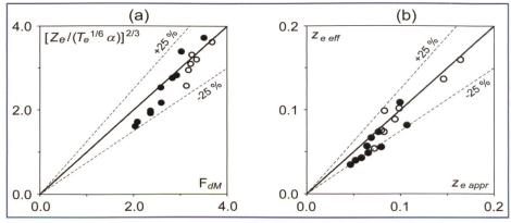
Bild 6. Vergleich der Endkolktiefen (a) Relative Endkolktiefe  $Z_e$  (• oder  $\circ$ ) beobachtet und (—) berechnet nach Gl. (9), (b) Absolutwerte  $z_e$  (•  $F_t < 0.9$ ;  $\circ$   $F_t \ge 0.9$ ).
