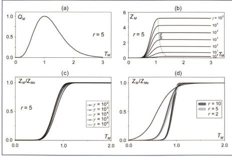
Bild 1. Berechnete zeitliche Entwicklung der Kolktiefe (a) Flutwelle für r=5 basierend auf Gl. (4), (b)  $Z_M(T_M)$  für verschiedene Werte  $\gamma$  und r=5, (c)  $Z_M/Z_{Me}(T_M)$  für r=5 und verschiedene Werte von  $\gamma$  und (d) mittlere Kurvenverläufe  $Z_M/Z_{Me}(T_M)$  für  $2 \le r \le 10$ .
