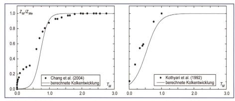
Bild 8. Vergleich der experimentell gemessenen temporären Kolkentwicklung aus den Literaturdaten (•) mit der nach Gl. (6) berechneten Tiefen (—).
