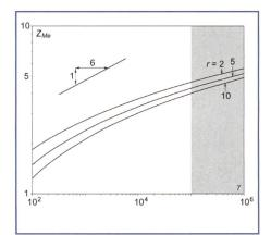
Bild 2. Doppelt-logarithmische Darstellung der Endkolktiefe  $Z_{Me}$  als Funktion von  $\gamma$  für r = 2, 5 und 10.
