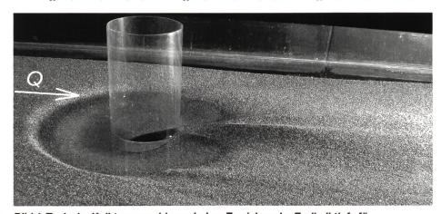
Bild 4. Typische Kolktopographie nach dem Erreichen der Endkolktiefe für  $Q = 0.05 \text{ m}^3/\text{s}$ ,  $h_M = 0.142 \text{ m}$ ,  $F_{dM} = 2.60$ ,  $t_M = 1800 \text{ s}$ , r = 10, D = 0.20 m,  $d_{50} = 1.14 \text{ und}$   $\sigma = (d_{84}/d_{16})^{1/2} = 1.18$ .
