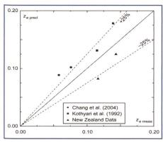
Bild 7. Vergleich der experimentell gemessenen Endkolktiefen aus den Literaturdaten (meas) mit den nach Gl. (9) berechneten Tiefen  $z_e/(h_M^{4/9} \cdot D^{5/9}) = \alpha \cdot F_{dM}^{3/2} \cdot T_e^{1/6}$  (pred).
