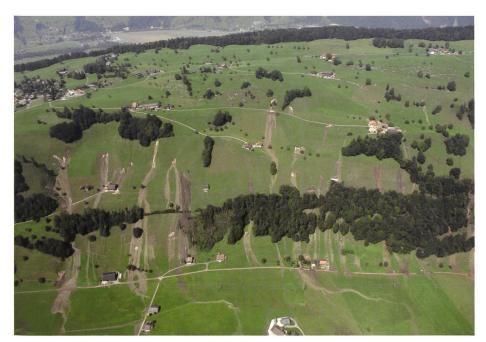
Bild 12. Rutschungen und Hangmuren am Mueterschwandenberg NW (Bild: Schweizerische Luftwaffe).
