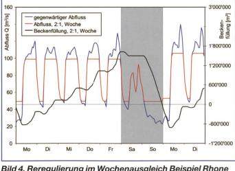
Bild 4. Reregulierung im Wochenausgleich Beispiel Rhone bei Branson. Gegenwärtige Abflussganglinie und reregulierter Abfluss für ein Schwall-Sunk-Verhältnis von 2:1 sowie Beckenfüllung.
