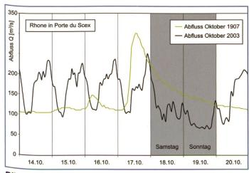
Bild 1. Ganglinie der Rhone bei Port du Scex Vergleich Oktober 1907 mit Oktober 2003 (Meile et al. 2005).
