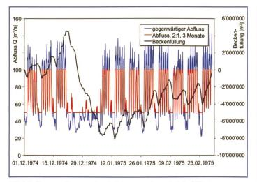
Bild 5. Reregulierung im 3-Monats-Ausgleich (Wintermonate Dez., Jan., Feb.) Beispiel Rhone bei Branson. Gegenwärtige Abflussganglinie und reregulierter Abfluss für ein Schwall-Sunk-Verhältnis von 2:1 sowie Beckenfüllung.
