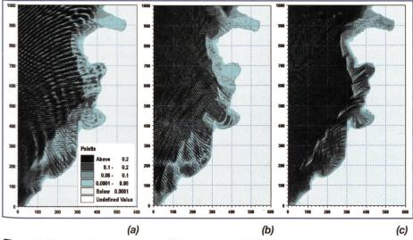
Figure 6. Hauteur des vagues en mètres montrant l'effet du régime de vent au lac de Bienne sur l'efficacité des mesures de protection dans l'amortissement des vagues incidentes pour le niveau du lac MWL et une période de retour Tr = 5 ans: (a) Vent; (b) Joran; (c) Bise.
