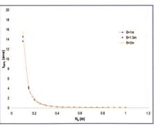
Figure 15. Période de demi-vie du projet de remblayage de la plage de Préverenges en fonction de la hauteur de vague  $H_b$  pour une longueur de remblayage de 300 m et pour  $h_l$  = 6,41m.
