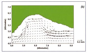
Figure 12. Courants littoraux générés dans des conditions de vents dominants: (a) Vent du sud-ouest; (b) Bise du nord-est.
