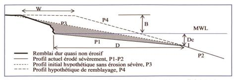
Figure 14. Profils réel (P1-P2), initial hypothétique (P3) et de remblayage (P4) de la plage.
