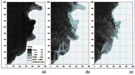
Figure 5. Hauteur des vagues en mètres montrant l'effet de la variation du niveau du lac de Bienne sur l'efficacité des mesures de protection dans l'amortissement des vagues incidentes pour un régime de Joran et une période de retour Tr = 5 ans: (a) Hautes eaux MHWL; (b) Niveau moyen MWL; (c) Basses eaux MLWL.
