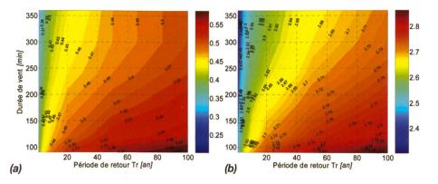
Figure 4. Caractéristiques de vagues en régime de Vent pour différentes périodes de retour: (a) hauteurs en mètres; (b) périodes en secondes.
