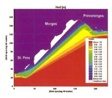
Figure 11. Début de la réfraction des vagues incidentes sur la plage de Préverenges au niveau de St-Prex (modélisation numérique en utilisant MIKE 21 pour Tr = 50 ans). La Palette des valeurs indique la hauteur des vagues en mètres.
