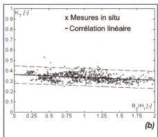
Figure 2. Mesures réalisées in situ: (a) vitesses de vents à Neuchâtel ( $U_L$ ) comparées a celles mesurées à Mörigen ( $U_W$ ); (b) coefficient de transmission  $K_T$  des barrages à claire-voie à Mörigen sur le lac de Bienne en fonction de la revanche relative  $R_c/H_i$  (BFH 2005).
