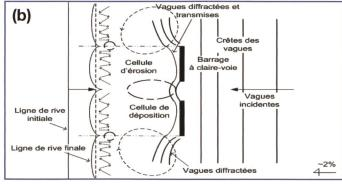
Figure 5. Zones de dépôt et d'érosion derrière un barrage à claire-voie: (a) structure simple; (b) structure double.
