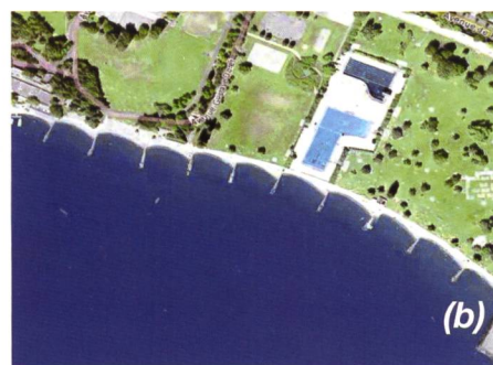
Figure 1. Protection des rives par des mesures souples: (a) protection des roselières par des barrages à claire-voie sur le lac de Bienne; (b) stabilisation par matériaux fins et épis à Bellerive sur la rive nord du Léman.
