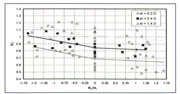
Figure 7. Coefficient de transmission  $K_T$  d'une palissade en fonction de la revanche relative  $R_c/H_i$ , pour différentes valeurs d'espacement latéral e,
