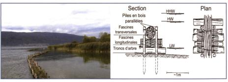
Figure 2. Implantation et construction de barrages à claire-voie sur le lac de Bienne.
