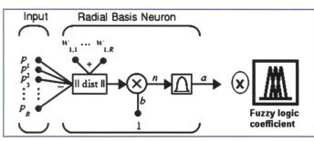
Bild 5. Schematische Darstellung des Zoobenthos-Moduls. Die Eingangsgrössen sind flussspezifische Taxabeobachtungen und physikalische Parameter. Die «radial basis neuron» liefert den PSRI-Wert, die Fuzzy Logik Koeffizient simuliert den Schwall- und Sunk-Effekt. Das Resultat ist eine flussabschnittsabhängige Prognose der Artenvielfalt.
