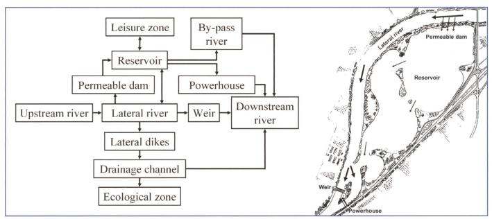
Bild 1. Links: Module eines Mehrzweckspeichers. Rechts: Konkretes Beispiel eines Mehrzweckspeichers [9].
