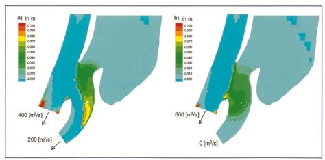
Bild 6. Einfluss des Kraftwerkbetriebs auf die Verlandungszonen (dm = 0,02 mm, Simulationsdauer 24 h, Suspensionsfracht 1 g/l). Durchströmung des Staubeckens mit 5  $\rm m^3/s$ . a) 200  $\rm m^3/s$  über Krafthaus, 400  $\rm m^3/s$  über Wehranlage. b) Gesamter Abfluss von 600  $\rm m^3/s$  über Wehranlage.
