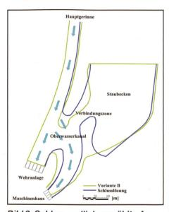
Bild 3. Schlussendlich gewählte Anordnung mit Modifikationen gegenüber der rein hydraulisch optimalen Lösung.
