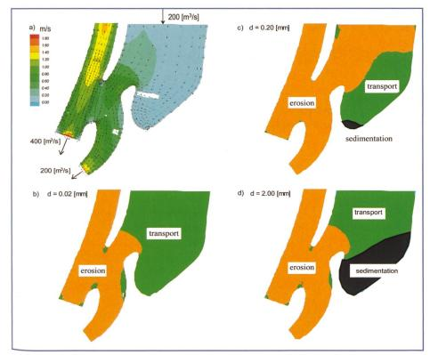
Bild 7. Wirksamkeit der Spülung durch Absenken des Stauspiegels um 2 m und Erzeugen einer Durchströmung von 200 m³/s. a) Strömungsbild und Geschwindigkeiten während Spülung. b) Erosions-, Transport- und Ablagerungszonen gemäss Hjulström für dm = 0,02 mm. c) Dito für dm = 0,2 mm. d) Dito für 2,00 mm.
