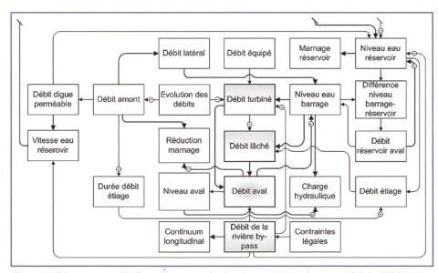
Figure 2. Diagramme d'influence; exemple du réseau hydraulique partiel; le débit de la rivière by-pass, le débit turbiné et le débit lâché influencent directement le débit aval.
