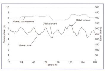
Figure 7. Régulation hebdomadaire estivale du réservoir et de la rivière aval avec 30 cm d'amplitude et 8 cm/h de gradient, régulation a priori.
