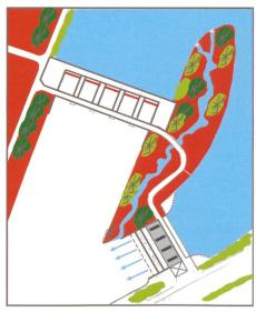
Bild 2. Schematische Anordnung von Wehr (links), Kraftwerkszentrale (rechts) und Trenninsel mit Umgehungsgerinne. Um das Gefälle des Umgehungsgerinnes zu beschränken, kann die Trenninsel resp. der Unterwasserkanal unterwasserseitig verlängert werden.
