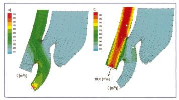
Bild 4. Strömung und Geschwindigkeitsverteilung für die gewählte Anordnung: a) Normalbetrieb des Maschinenhauses mit 200 m<sup>3</sup>/s (links), b) Hochwasserabfluss mit 1000 m<sup>3</sup>/s über Wehr (rechts).
