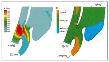
Bild 5. a) Berechnete Verlandungszonen (dm = 0,02 mm, Simulationsdauer 24 h, Suspensionsfracht 1 g/l). b) Erosions-, Transport- und Ablagerungszonen gemäss Hjulström. Durchströmung des Staubeckens mit 5 m³/s.
