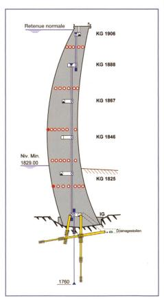
Figure 3. Coupe typique d'un barragevoûte.
