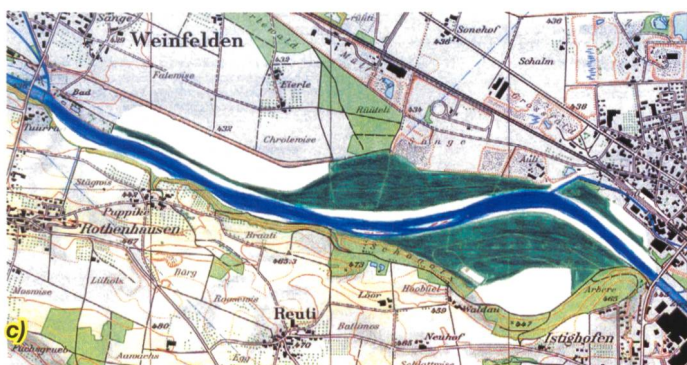
Bild 3. Beispiel von Wasserbauvarianten für das Fallbeispiel Weinfelden-Bürglen. Die Kantonsvariante (a) beinhaltet ein Rückhaltebecken für den Hochwasserschutz und eine Aufweitung des Flussbettes, die Variante Naturreservat (b) setzt auf ökologische Aufwertung, die Minimalvariante (c) beinhaltet eine Verdoppelung des Flussbettes, und die Kombinationsvariante (d) verbindet die Ziele «Hochwasserschutz», «Erhaltung Landwirtschaftsland» und «ökologische Aufwertung». Quelle: Hostmann (2005).
