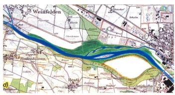
Bild 3. Beispiel von Wasserbauvarianten für das Fallbeispiel Weinfelden-Bürglen. Die Kantonsvariante (a) beinhaltet ein Rückhaltebecken für den Hochwasserschutz und eine Aufweitung des Flussbetts, die Variante Naturreservat (b) setzt auf ökologische Aufwertung, die Minimalvariante (c) beinhaltet eine Verdoppelung des Flussbettes, und die Kombinationsvariante (d) verbindet die Ziele «Hochwasserschutz», «Erhaltung Landwirtschaftsland» und «ökologische Aufwertung». Quelle: Hostmann (2005).
