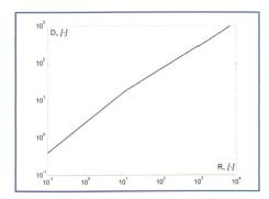
Figure 10. Relation entre le diamètre adimensionnel du sable et le nombre de Reynolds des grains décrivant le début d'entraînement (Bonnefille 1992).
