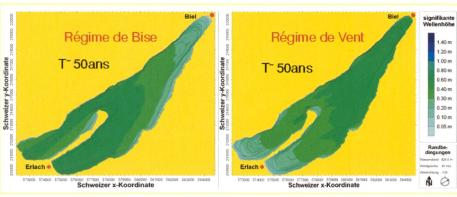
Figure 5. Modélisation numérique de champs des vagues sur le lac de Bienne à l'aide du modèle SWAN (Booij et al. 1996) pour les régimes de Bise (à gauche) et de Vent (à droite), pour une période de retour T=50ans.
