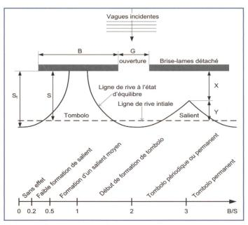
Figure 11. Comportement d'un brise-lames non poreux (Sayah 2006).
