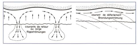
Figure 9. Différents régimes de transport solide littoral; à gauche, vagues perpendiculaires à la rive induisant un transport solide perpendiculaire à la rive; à droite, vagues incidentes obliques à la rive, induisant un transport en dents de scie.
