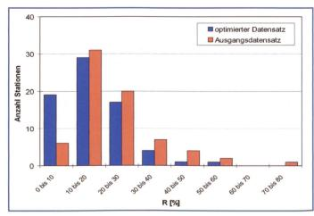
Bild 5. Histogramme der Schätzfehleranalyse für den mittleren Jahresabfluss (links) und die Kenngrösse R (rechts).
