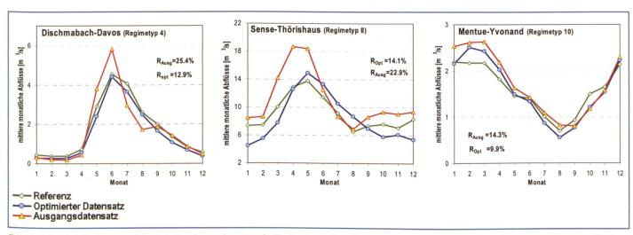
Bild 7. Vergleich des aus Messdaten berechneten (= Referenz) und des aus dem optimierten Datensatz bestimmten Verlaufs der mittleren monatlichen Abflüsse mit Fallbeispielen einer alpinen, einer voralpinen und einer Validationsstation aus dem Mittelland; zusätzlich ist auch die mit dem Ausgangsdatensatz ermittelte Ganglinie dargestellt und die Verbesserung des R-Wertes durch die Optimierung angeführt.
