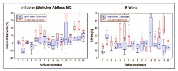
Bild 6. Nach Abflussregimetypen differenzierte Analyse der Schätzgenauigkeit; die Boxplots geben auf der Basis der Validationsstationen pro Abflussregimetyp die Verteilung (Median, 25/75% Quantil und Min/ Max) der Schätzfehler wider.
