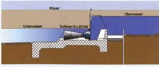
Die Vorstudie des vorgelagerten Dotier-Kraftwerks Stroppel empfahl den Einsatz von Kleinturbinen.
